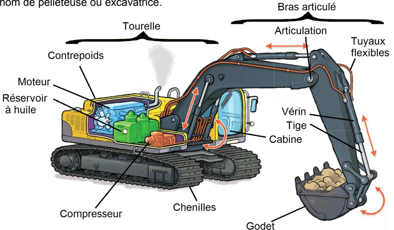
La pelle hydraulique est constituée d'un châssis porteur à chenilles (ou à pneus,) surmonté d'une tourelle pouvant tourner sur 360 degrés. Cette tourelle porte le moteur, les organes hydrauliques (pompe, moteurs, vérins), le poste de conduite, le contrepoids et l'équipement (bras articulé et godet).
