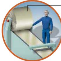
Les bobines mesurent 1,60 m de diamètre et pèsent environ 15 tonnes. Elles sont formées d'une feuille de 80 à 90 cm de large et 10 km de long roulée sur elle-même.
