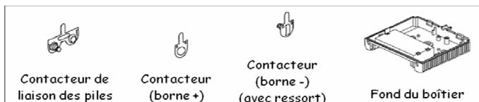
**PHASE 13** : Placer les contacteurs (double **Z**) et le contacteur (simple **AC** et **AB**) dans le logement des piles au fond du boîtier puis replier les ergots. Plier à 90°
